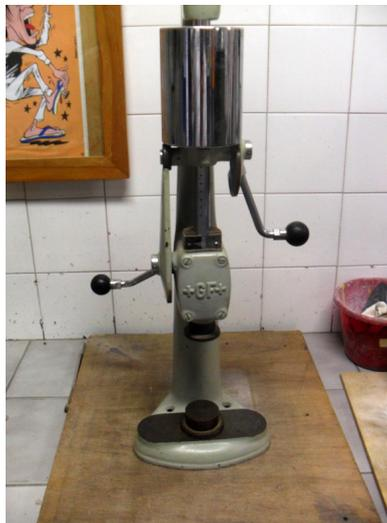
**Figura 3** Martelete para determinação da compactabilidade
