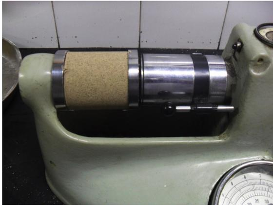
**Figura 6** Máquina universal de ensaios em areia à verde com corpo de prova
