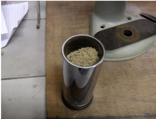
**Figura 2** Cilindro padrão com areia de moldagem
