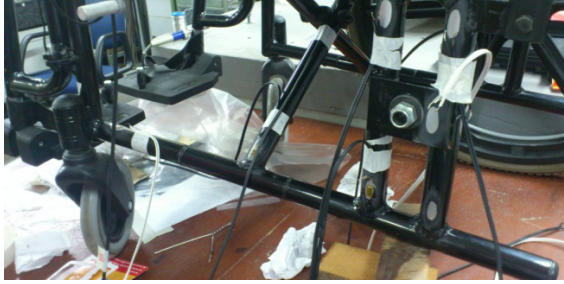
Figura 8 Extensômetros devidamente posicionados
