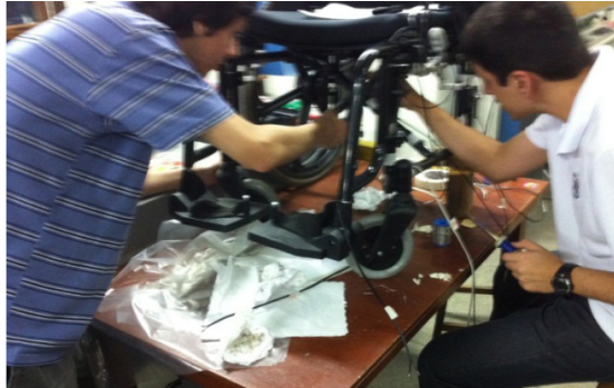
Figura 3 Processo de colagem e posicionamento dos extensômetros
