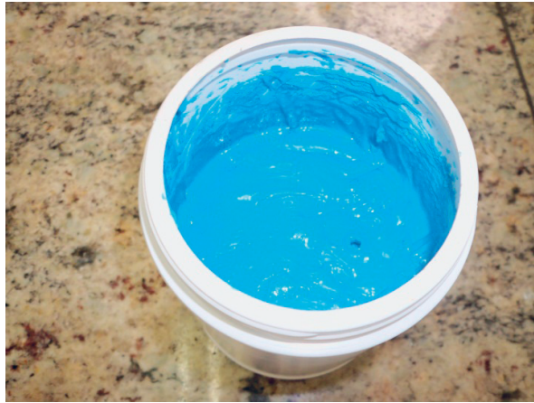
Figura 3 Amostra de plastisol após processo de fabricação em laboratório
