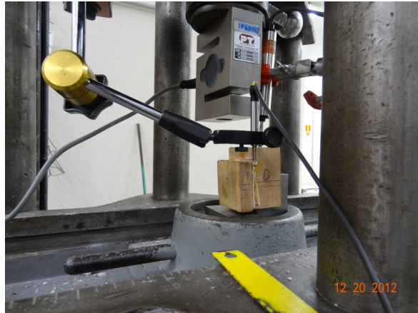
Figura 7 Ensaio de cisalhamento na lâmina de cola
