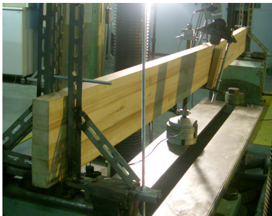
Figura 5 Ensaio de flambagem lateral da viga de MLC de seção transversal retangular de 40 mm x 192 mm
