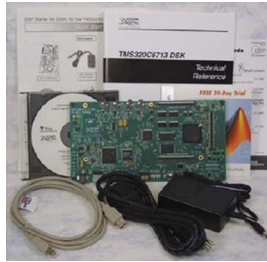
Figura 2 Módulo de avaliação de hardware do DSP TMS320C6713 da Texas Instruments.
