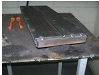
**Figura 5** Fixação das chapas no dispositivo.
