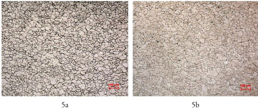
**Figura 5** Micrografias observadas por microscopia óptica (a) antes e (b) depois do envelhecimento a 170 °C/20 min.
