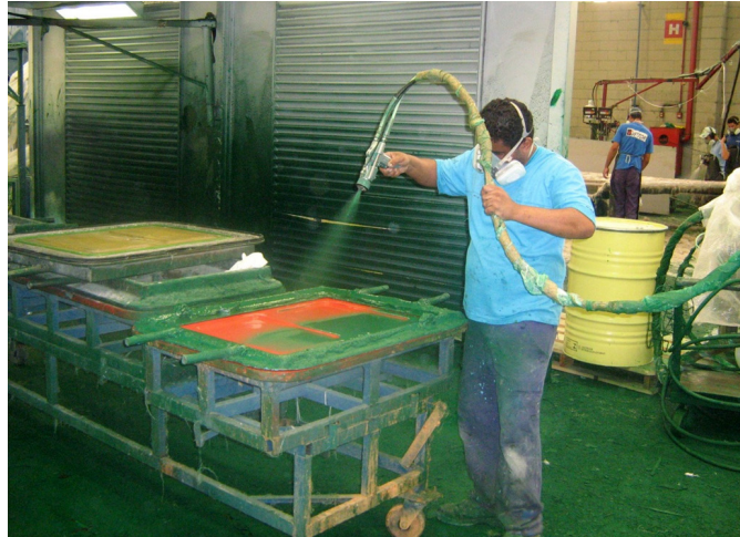
Figura 5 Aplicação do gelcoat e pintura do molde com pistola automática.
