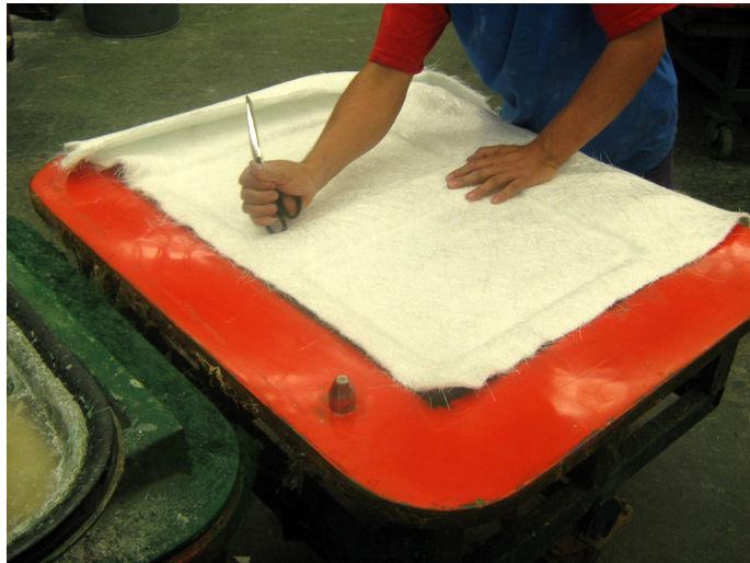
Figura 6 Ilustração do início da aplicação da manta de reforço.
