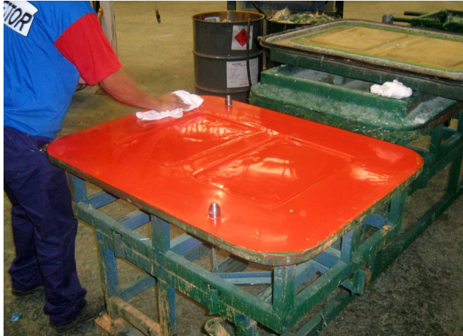
Figura 3 Limpeza do molde com flanela embebida com álcool etílico.
