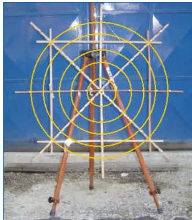
**Figura 2** Estrutura de suporte da antena receptora.
