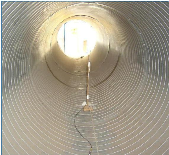
**Figura 3** Antena transmissora posicionada no interior do duto.
