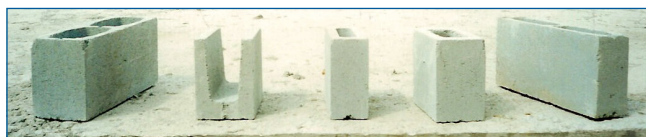
Figura 8 Cinco tipos de blocos pré-moldados de concreto.
