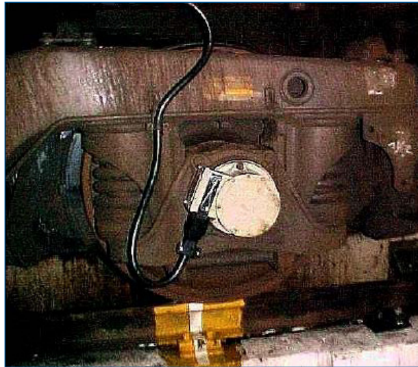
Figura 1 Tacômetro instalado no truque do trem.
