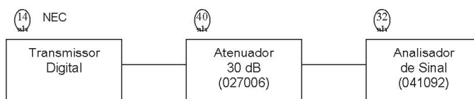
Figura 34 Set up para ajuste de potência de saída do transmissor de TV Digital
