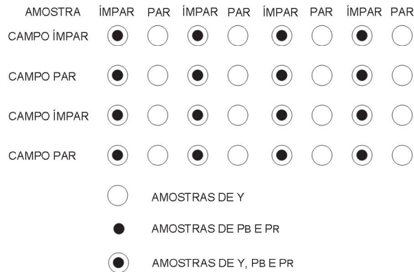
Figura 13 Detalhes da estrutura de amostragem do formato 4:2:2
