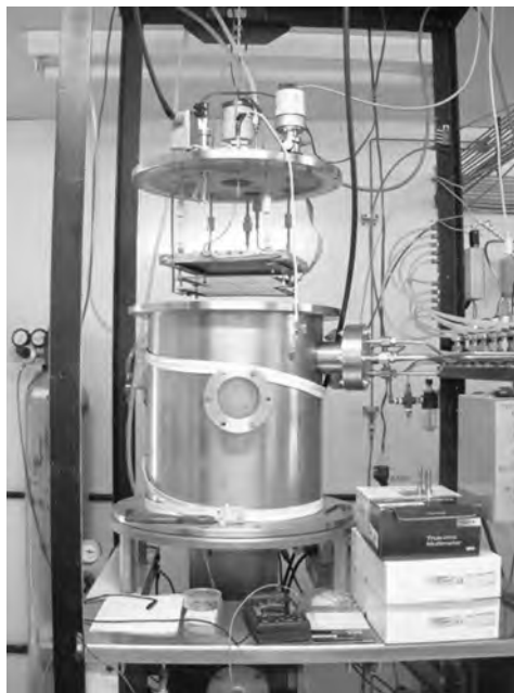
Figura 3 Reator por processamento de plasma, com porta amostra visto no topo – Laboratório de Microeletrônica da Universidade de São Paulo
