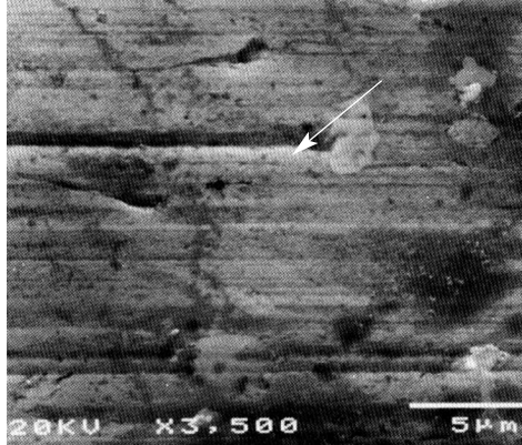
Figura 8 Imagem de elétrons secundários. Seta indicando risco interrompido em fase identificada como carboneto
