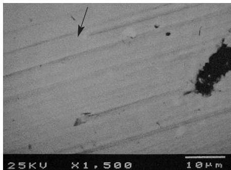
Figura 7 Imagem de elétrons retroespalhados (fases constituídas por elementos mais pesados são mais claras). Setas indicando risco interrompido em fase identificada como carboneto
