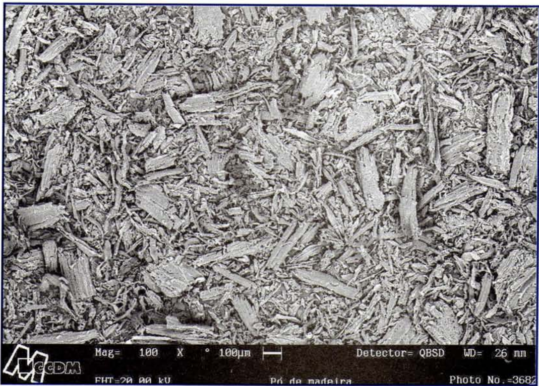
Figura 6 Micrografia do pó de madeira (WF) com 100 vezes de aumento
