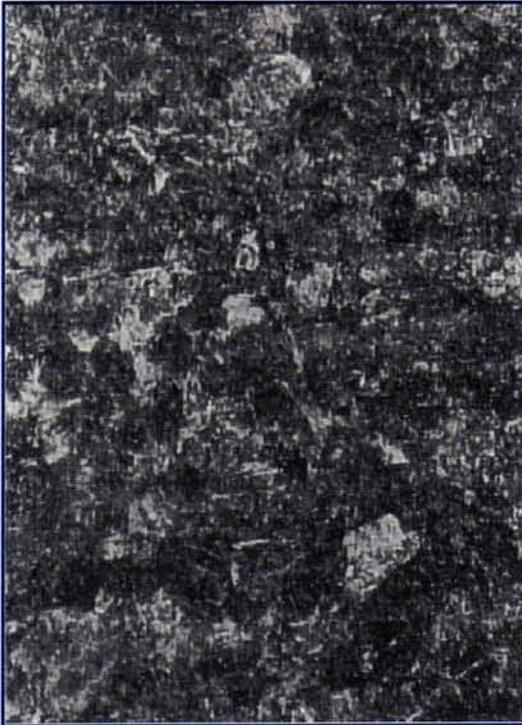
**Figura 7** Microestrutura para austenitização a 860°C e revenido a 540°C. Ataque com reativo de Vilella 200x
