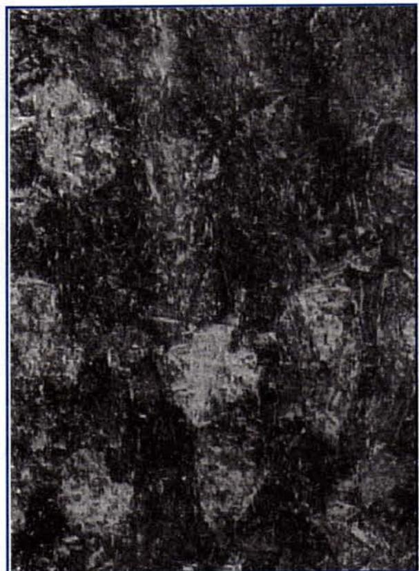
**Figura 6** Microestrutura para austenitização a 1.000 + 860°C e revenido a 540°C. Ataque com reativo de Vilella 200x
