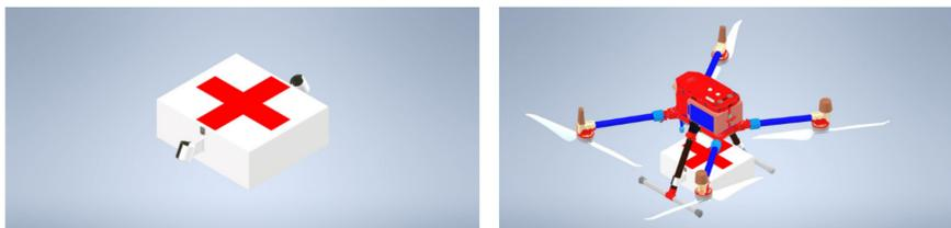
**Figura 1** Dispositivo fechado (imagem à esquerda) e dispositivo acoplado ao *drone* DJI Matrice 300 RTK (imagem à direita)
