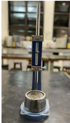
**Figura 4** Aparelho de Vicat com sonda de Tetmajer
