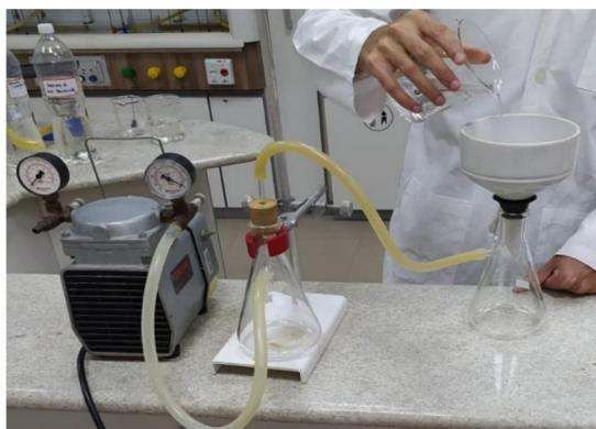
**Figura 5** Sistema de filtração a vácuo com funil de Büchner
