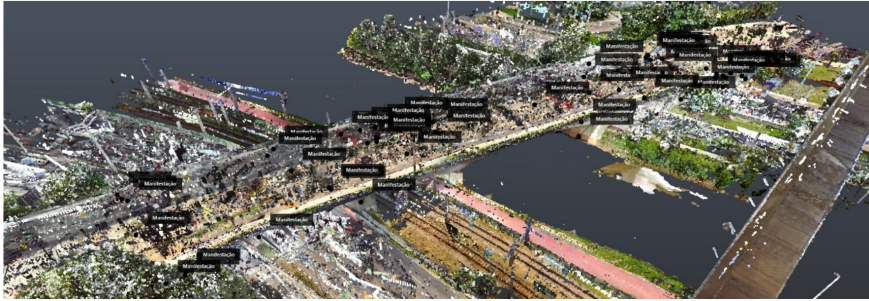
Figura 4 Nuvem de pontos processada no Autodesk ReCap Pro com marcação das 49 manifestações patológicas identificadas durante navegação pelo modelo
