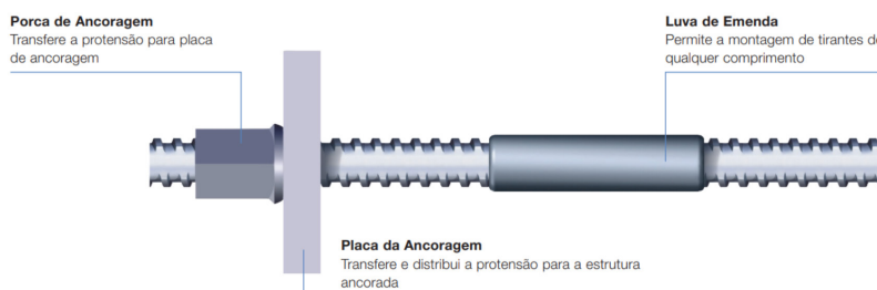
Figura 2 Tirante monobarra DYWIDAG
