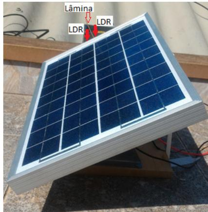
**Figura 12** Teste do sistema de rastreamento.
