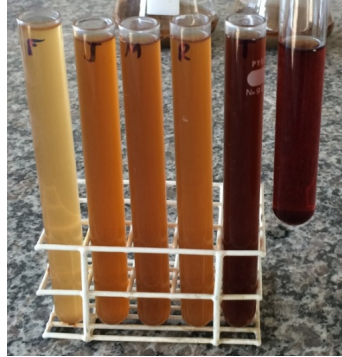
Figura 3 Resultado do ensaio de impurezas orgânicas. Da esquerda para direita: Franca, Juquiá, Mogi-Guaçu, Registro, Taubaté e solução padrão de ácido tânico.
