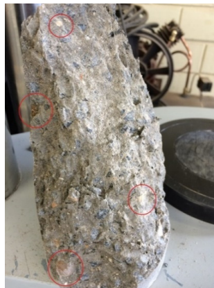
Figura 8 Corpo de prova produzido com areia de Registro, apresentando seixos rolados cisalhados no ensaio de compressão de 7 dias.
