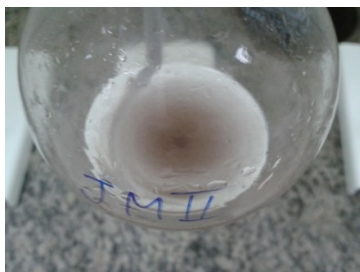
Figura 6 Sombra C após digestão ácida.
