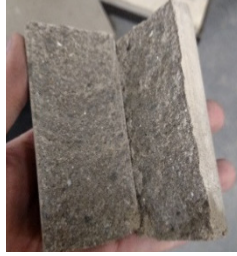
Figura 9 Corpo de prova rompido por compressão diametral.
