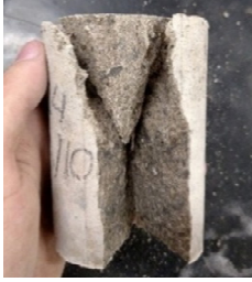
Figura 8 Corpo de prova rompido por compressão uniaxial.
