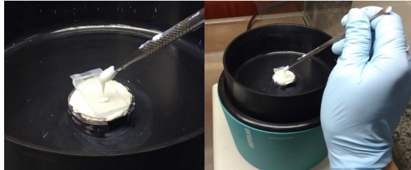
Figura 3 Deposição de \text{TiO}_2 sobre a placa já fixada no spin coater .
