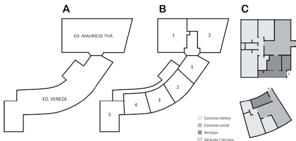
Figura 9: Edifício Maurício Thá e Edifício Veneza, 1967. A) Diagrama de implantação; B) Diagrama com unidades por pavimento nos dois edifícios; C) Diagramas com distribuição funcional das unidades 1 e 3, respectivamente. Fonte: Elaborado pelo autor.
