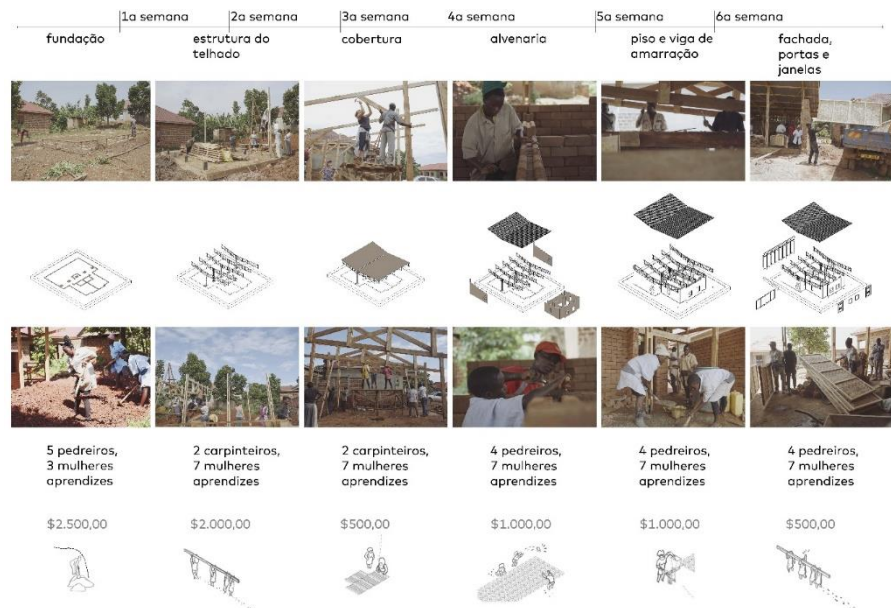
Figura 7: A fase de construção durou 6 semanas e serviu como oficina de formação para as mulheres locais. Os fundos foram angariados por meio de uma campanha de financiamento coletivo. O processo de construção incluiu 6 colaboradoras estrangeiras, 2 carpinteiros, 4 profissionais da construção civil e 7 mulheres aprendizes. Fonte: arquivo pessoal de Thais Viyuela. al de Mariana Montag.
