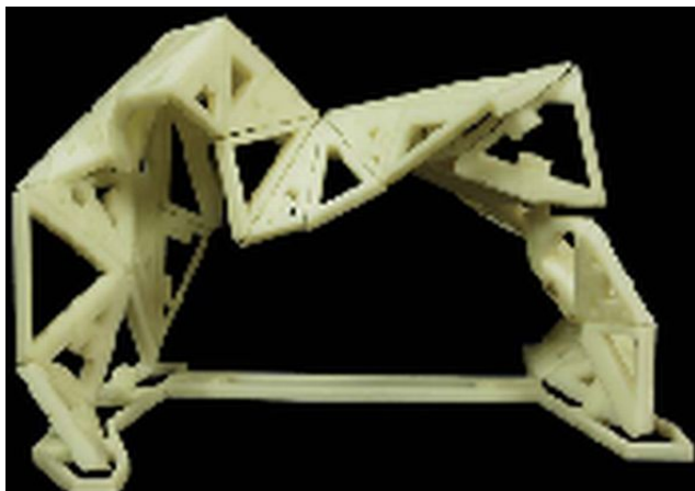
Figura 7: Exemplo de objeto feito em FDM (SASS, 2006g)
