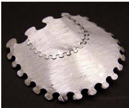
Figura 2: Exemplo de objeto metálico cortado com a cortadora a jato de água (KILIAN, 2003)
