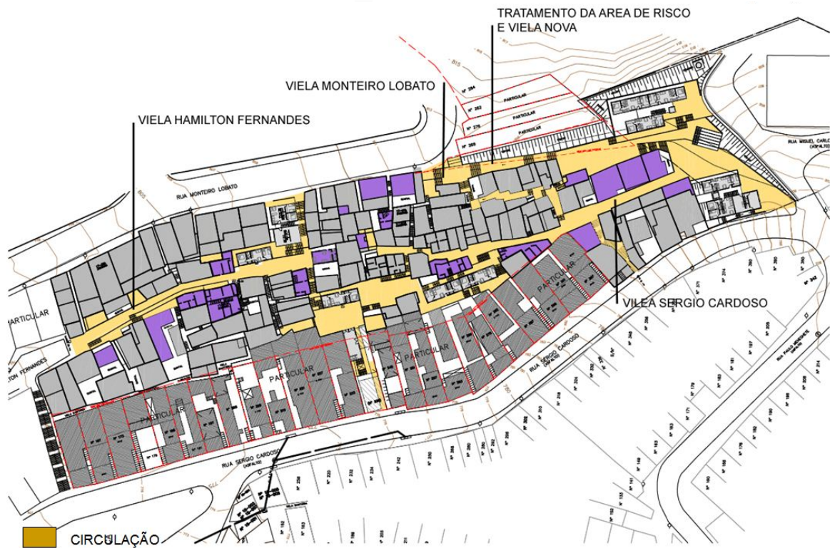
Figura 7: desenho de implantação do projeto: em ocre circulação e novos “largos” e pequenas praças, em roxo casas retificadas, desenho com layout correspondem aos térreos dos novas blocos construídos. Fonte: Barossi Nakamura arquitetos.
