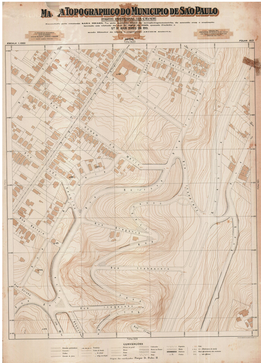
Fig. 10 - O traçado viário foi executado com grande aderência às curvas de nível, evitando cortes e aterros desnecessários. Observar as soluções engenhosas adotadas em situações de declive abrupto, com a utilização de curvas de grande angulação, que são amenizadas pela adoção de uma terceira rua, retilínea, vencendo "a pique" a conexão com o fundo do vale. Essas curvas de grande convexidade, presentes nas de 8 mts de largura, servem como mirantes para contemplação do vale. Fonte: SMDU, PMSP.
