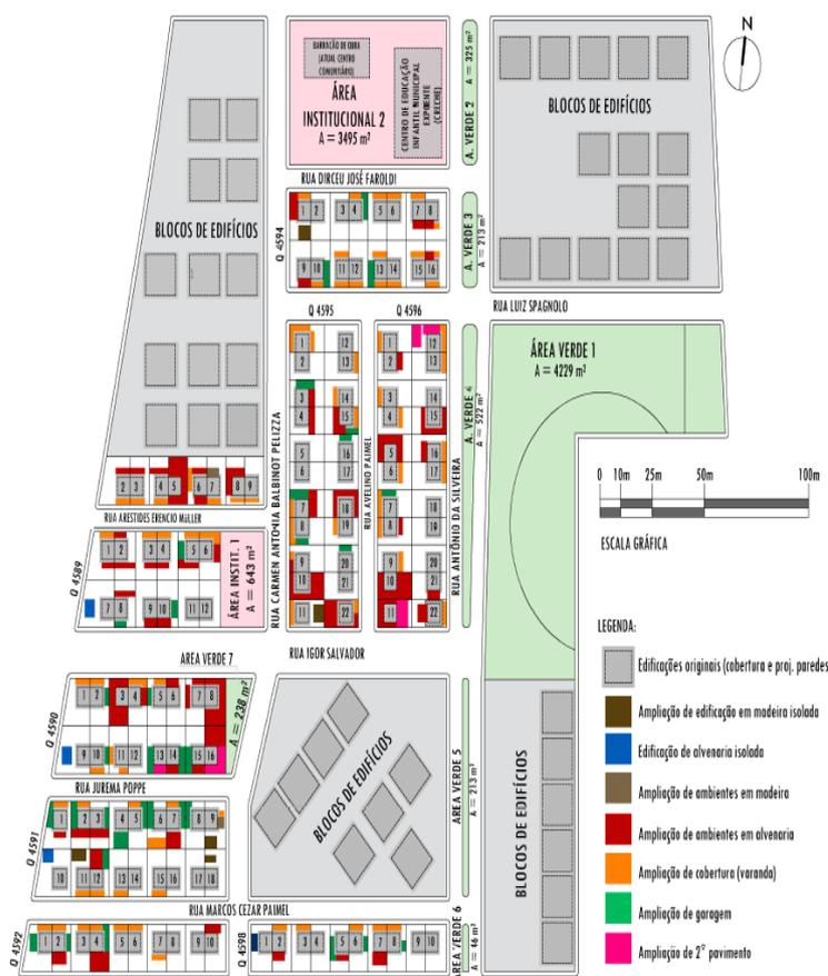
Figura 8: Implantação geral do conjunto e modificações realizadas nas unidades térreas. Fonte: Elaborada pelos autores.
