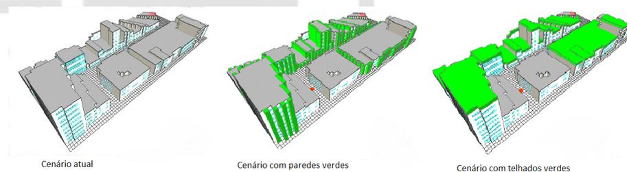
Figura 4: Configuração modelada no *software* ENVI-met, para os cenários simulados. Fonte: Neves (2017).
